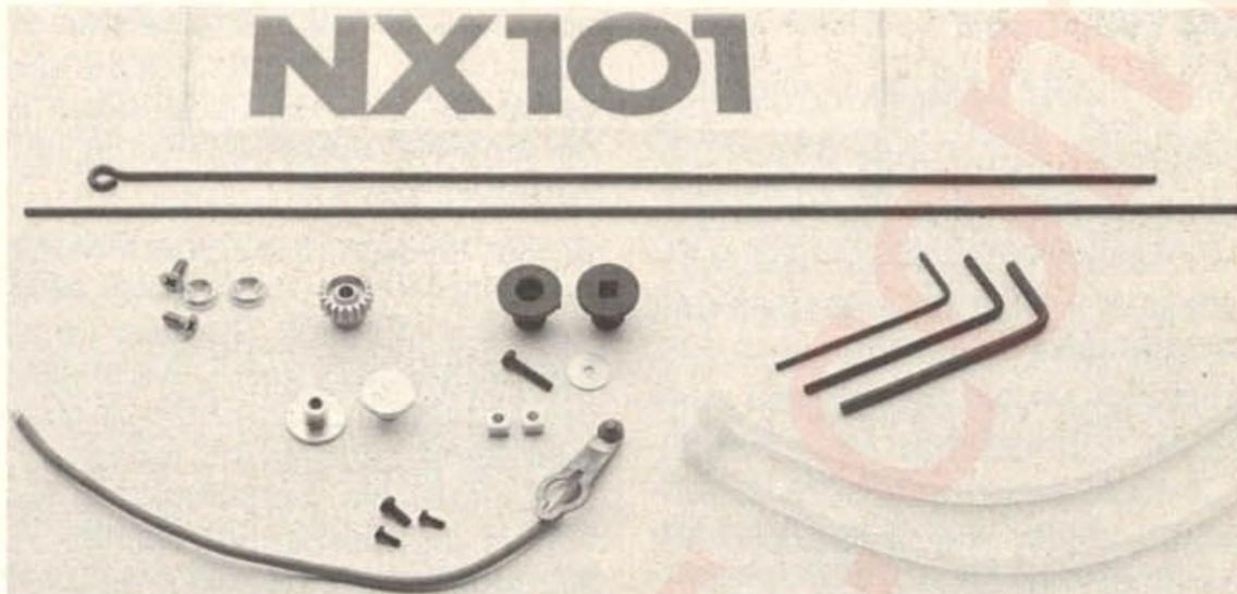
Überrollantenne/Akku Befestigung/Servo Saver O.A./ Servo Höhenverstellung/verschiedene Servo Einsätze/ 18er Ritzel/Motorbefestigung plus Distanzstücke/Spoilerdraht Spoilerhalterung/Lexan Leichtkarosse 40 Gramm O.A.
